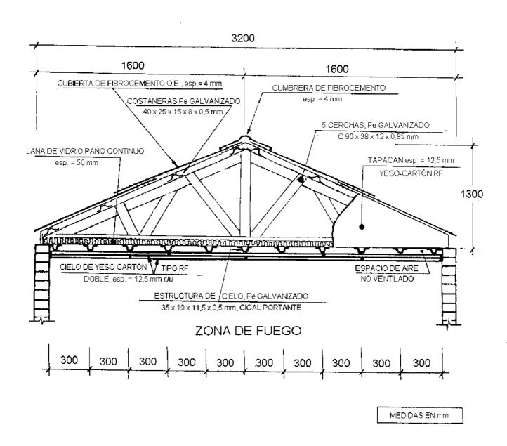
Figura 1. Esquema de la techumbre de Cintac S.A., ensayada.
